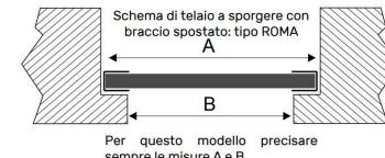
Schema di telaio a sporgere con braccio spostato: tipo ROMA
