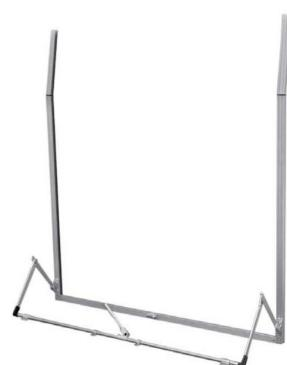
Telaio a sporgere in **alluminio a leva centrale**, attacco standard (a sx) e attacco tipo ROMA (a dx). Guide 32x28 in alluminio con guarnizione, parte superiore spaccata per invito tapparella e fori per posa in opera.
