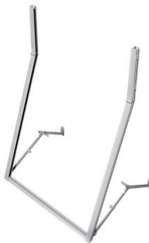
Telaio a sporgere in **alluminio a leva laterale**, attacco standard (a sx) e attacco tipo ROMA (a dx). Guide 32x28 in alluminio con guarnizione, parte superiore spaccata per invito tapparella e fori per posa in opera.
